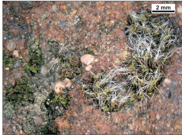
Ryc. 3. Mech w porach rudy darniowej z murów grobowca w stylu rzymskim w Miliczu (ul. Kasztelańska) Fig. 3. Moss in the pores of bog ore from the walls of a Roman-style tomb in Milicz (Kasztelańska Street)
