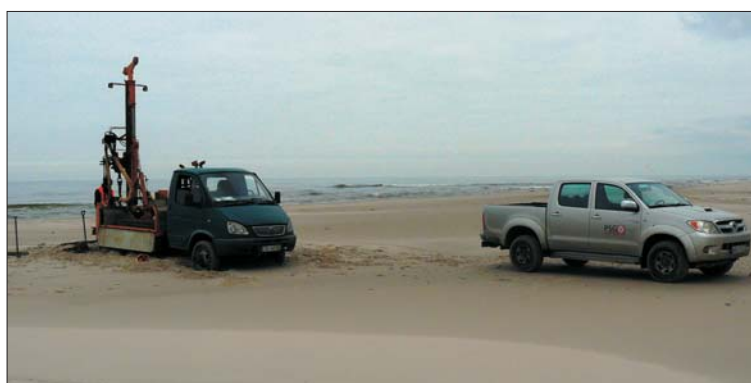
Ryc. 2. Wiercenia geologiczne w strefie brzegowej. Fot G. Uścińowicz Fig. 2. Geological drillings in the coastal zone. Photo by G. Uścińowicz
