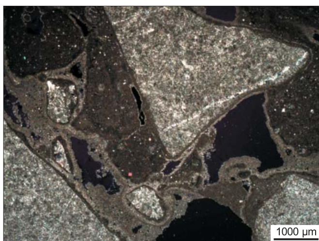
Ryc. 7. Mikroskopowy obraz brekcji dolomitycznej o spoiwie mikrytowym w świetle przechodzącym. Fot. M. Jaranowska
