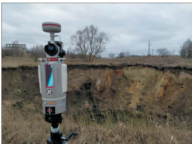
Ryc. 10. Naziemny skaner laserowy Riegl VZ-2000i podczas pracy. Fot. Z. Perski
