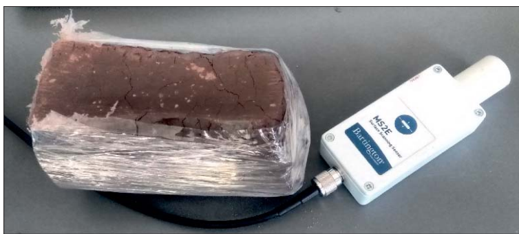
Ryc. 2. Fragment badanego rdzenia wraz z czujnikiem MS2E Fig. 2. Piece of tested core with MS2E sensor
