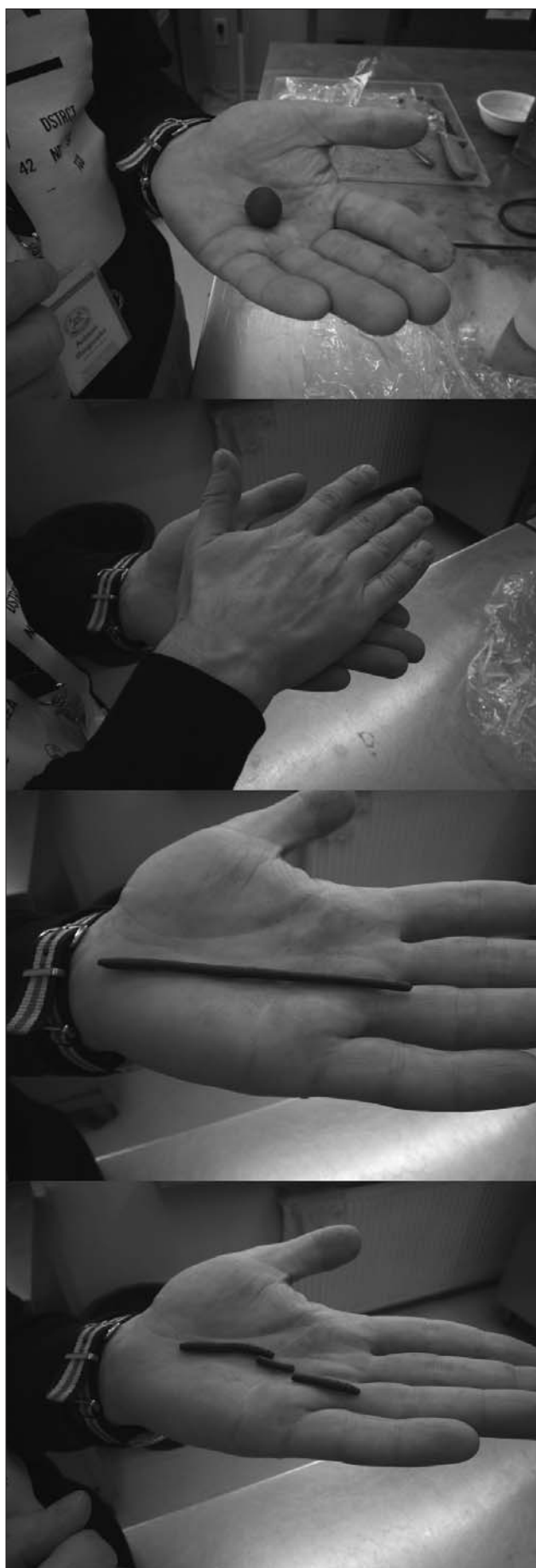
Ryc. 2. Test zwięzłości i plastyczności. Fot. A. Grabowska (2020 r.) Fig. 2. Toughness and plasticity test. Photo by A. Grabowska (2020)
