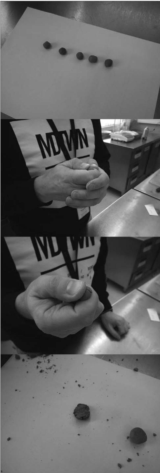
Ryc. 3. Test wytrzymałości w stanie suchym. Fot. A. Grabowska Fig. 3. Dry strength test. Photo by A. Grabowska
