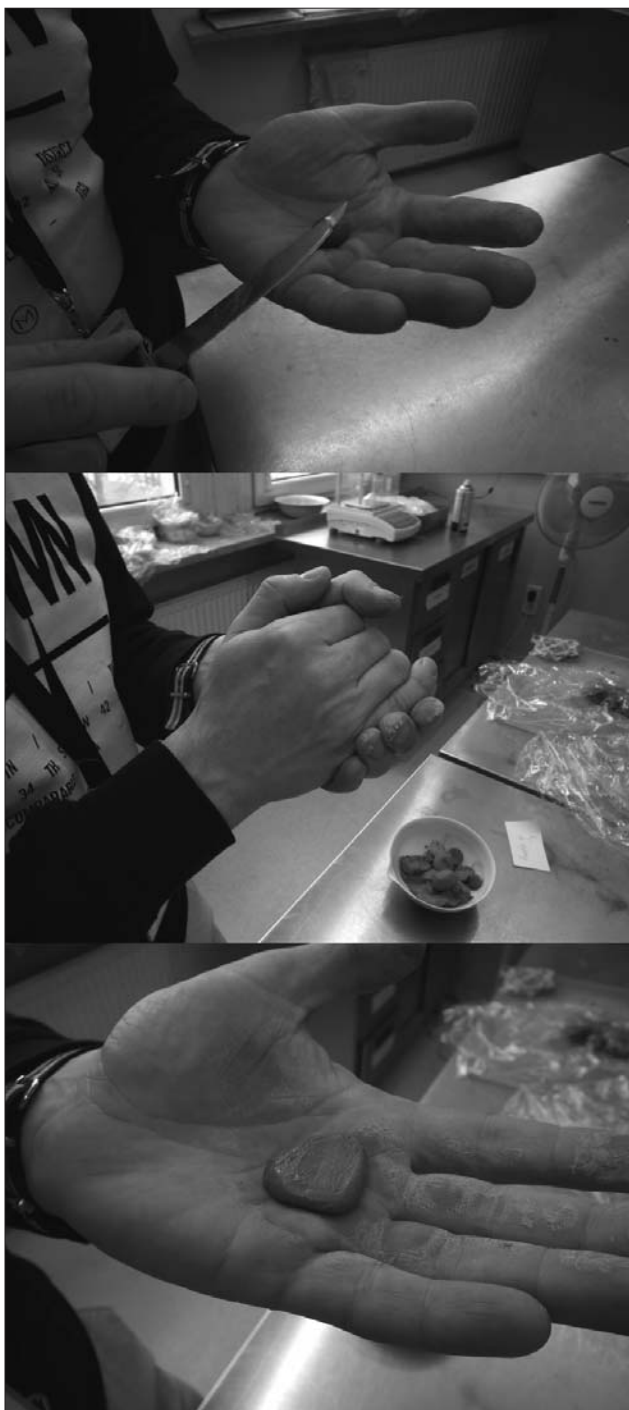
Ryc. 1. Test dylatacji. Fot. A. Grabowska Fig. 1. Dilatancy test. Photo by A. Grabowska
