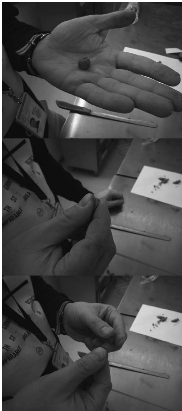
Ryc. 7. Test spójności. Fot. A. Grabowska Fig. 7. Cohesion test. Photo by A. Grabowska
