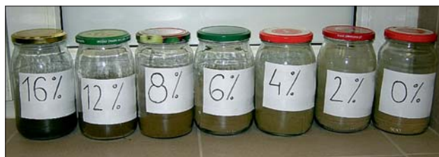
Ryc. 2. Seria próbek mad zanieczyszczonych olejem napędowym Fig. 2. Samples of muds contaminated with diesel fuel
