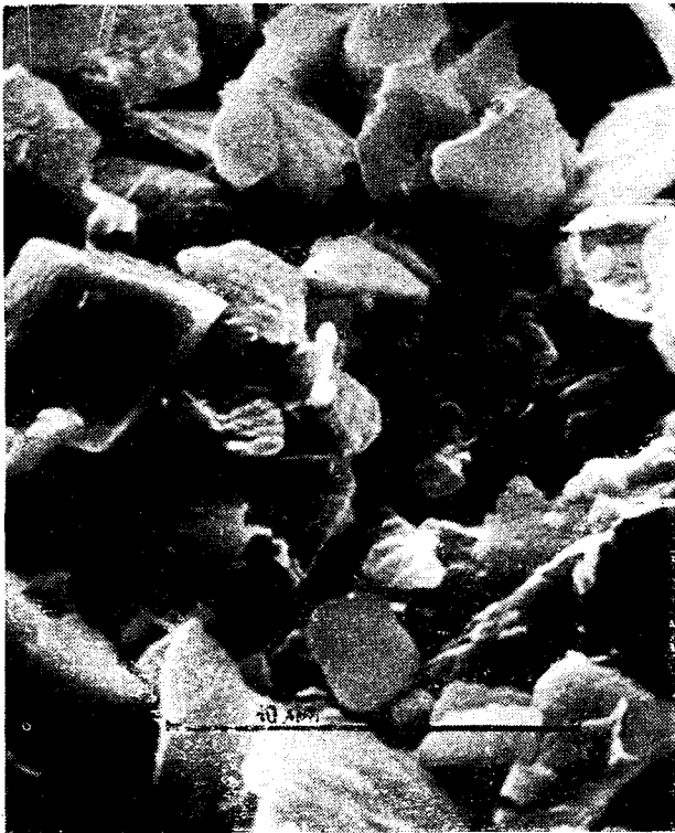
Ryc. 1. Powierzchnia strukturalna ilitu warstwowanego z Kampinosu (warstwa ciemna).
