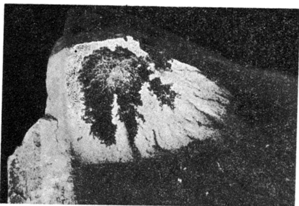
Ryc. 4. Krystalizacja galenitu na ściankach spękań w syderycie. Pow. 3,2 X.
