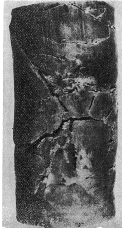
Ryc. 10a, b i c. Próbkę iltów poznańskich po ścinaniu w aparacie trójosiowym
