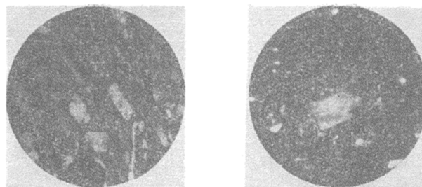
Ryc. 17. Przerost z pokładu „Franciszek Górny”. Wśród izotropowej masy skalnej widoczna grupa ziarn skałeni, ułożonych równolegle do podzielnosci skały. Po prawej stronie wkładki węgla (pola czarne). Nikole skrzyżowane, pow. 150 X.
