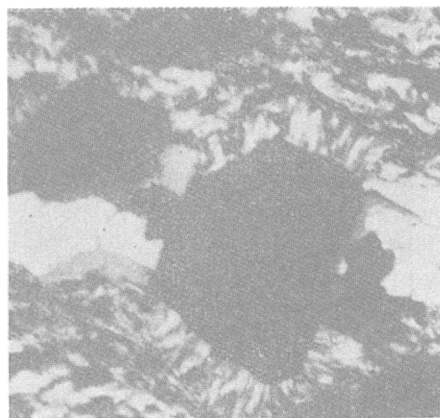
Ryc. 4. Wiercenie nr 17, głęb. 77 m. Łupek kwarcowo-chlorytowy z akcesorycznym serycytem, silnie okruszczony, o strukturze lepidoblastyczno-oczkowej. Porfiroblasty pirytu z wyciśniętymi kryształami kwarcu palisadowego na peryferii i z aureolą kwarcu promienistego wokół prakryształu. Minerale blaszkowate otaczają opływowo (fluidalnie) minerał kruszcowy.
