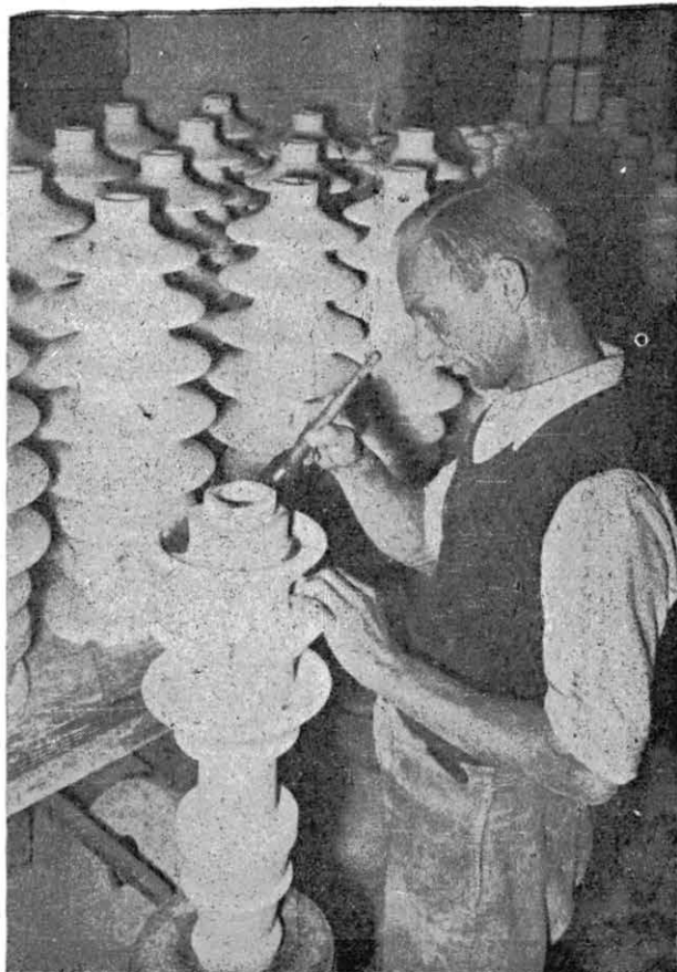
Wykańczanie izolatorów (fot. CAF)
