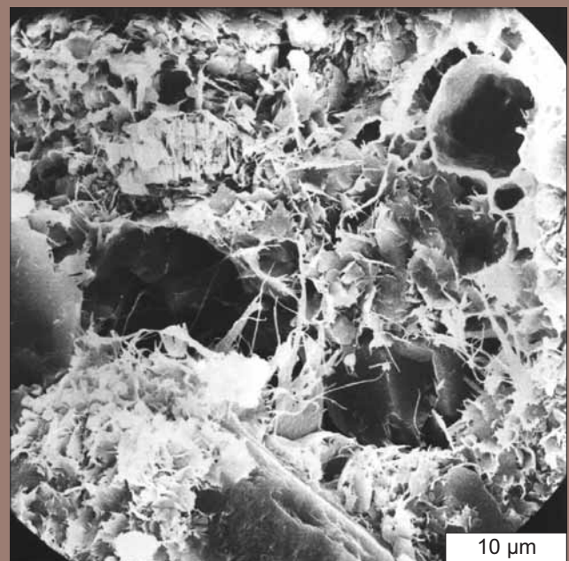
Ryc. 5. Illit włóknisty w przestrzeni porowej piaskowca. Obraz SEM. Otwór Korabiewice PIG 1, głęb. 4383,3 m Fig. 5. Fibrous illite in the sandstone pore space. SEM image. Borehole Korabiewice PIG 1, depth 4383,3 m
