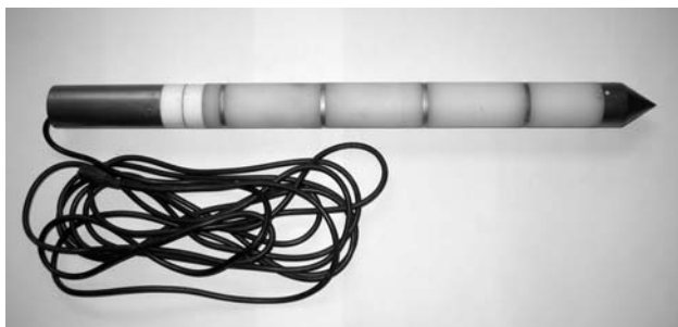
Ryc. 4. Sonda geoelektryczna do pomiarów oporności gruntu. Fig. 4. Geoelectrical equipment for the soil resistance measurement
