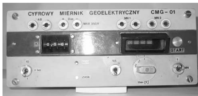
Ryc. 5. Cyfrowy miernik geoelektryczny służący do odczytywania wartości oporności gruntu Fig. 5. Digital geoelectrical gauge for soil resistance reading
