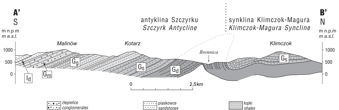
Ryc. 4. Przekrój geologiczny wzdłuż linii A'–B' na ryc. 2 (Burtan i in., 1937 — zmieniony). Pozostałe objaśnienia jak na ryc. 2
