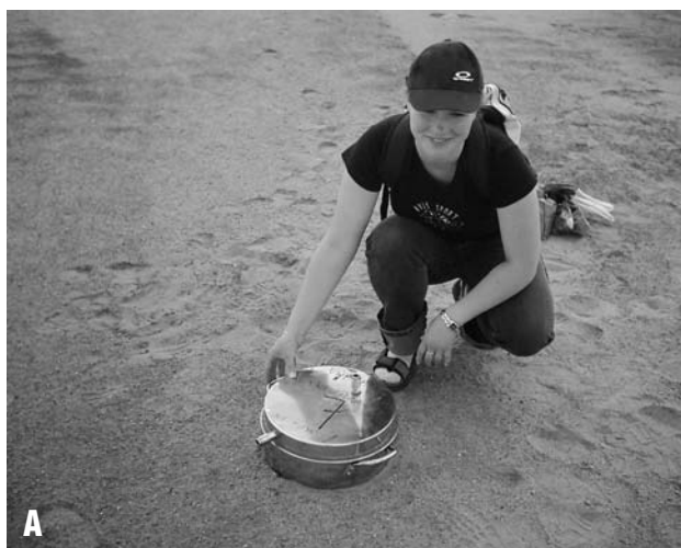
Ryc. 1A — Komora dyfuzyjna do pomiarów współczynnika ekshalacji radonu; B — pomiary terenowe ekshalacji radonu Fig. 1A — Diffusion chamber used for radon exhalation rate measurement; B — field measurements of radon exhalation
