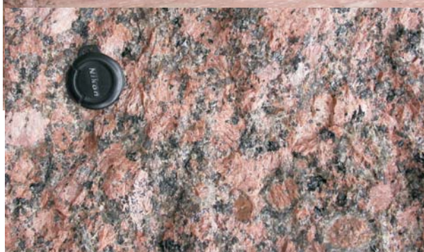
Ryc. 2. A — Kamieniołom pyterlitu Haikanvuori; B — pyterlit Haikanvuori z widocznymi, dużymi, różowymi skaleniami potasowymi. Niektóre skalenie mają charakterystyczne dla tekstury rapakiwi obwódki oligoklaznu
