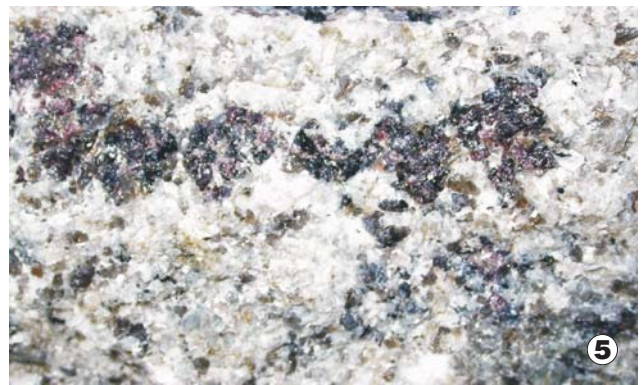
Ryc. 5. Późnoorogeniczny granit Keittomäki typu S z licznymi granatami (brązowofioletowe). Wielkość próbki ok. 10 cm
