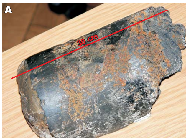
Ryc. 1. Rdzeń 30-centymetrowej długości pozyskany z otworu 5Kł z głębokości ok. 240 m; A — powierzchnia zewnętrzna; B — powierzchnia przecięcia; widoczne metalowe kształtki, wióry i druty
