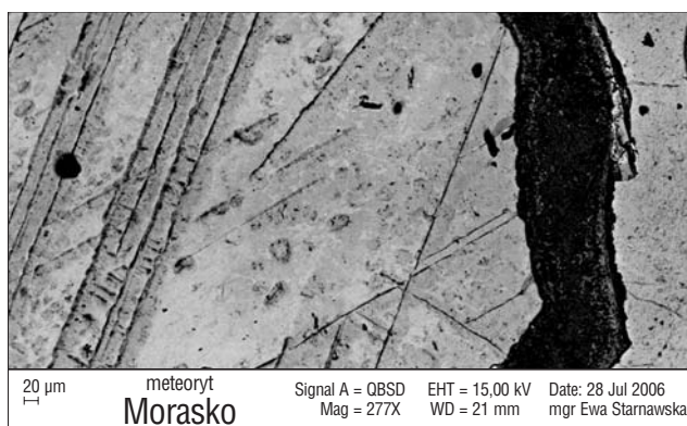
Ryc. 6. Struktura meteorytu Morasko trawionego nitałem. Widoczne linie Widmanstättena i Neumanna oraz strefy zawierające grafitopodobną materię węglistą oraz schreibersyt. Obraz z detektora elektronów wstecznie rozproszonych
