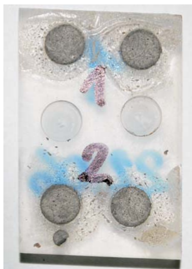
Ryc. 1. Próbką gotowa do oznaczenia składu pierwiastkowego z zastosowaniem spektrometrii mas z jonizacją w plazmie indukcyjnie sprzężonej
