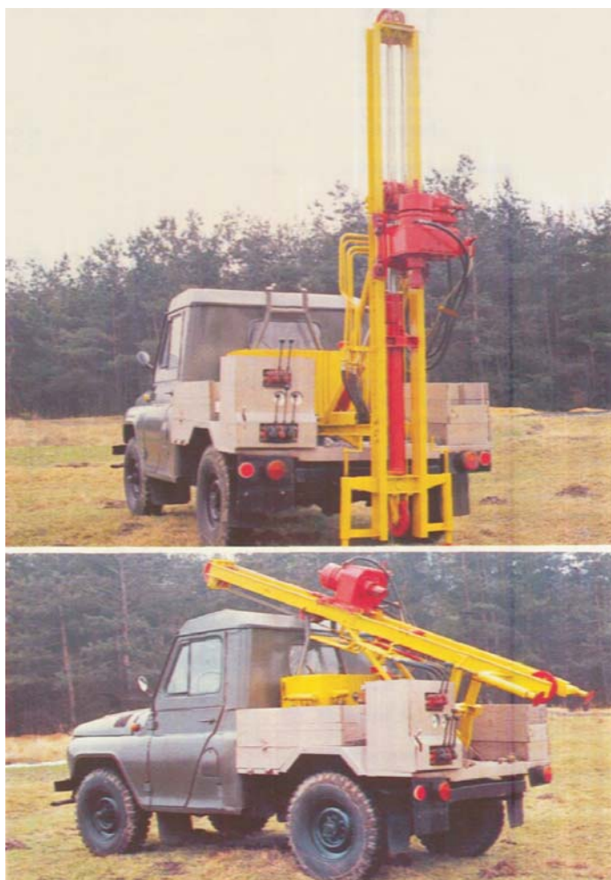
Ryc. 1. Urządzenie do wierceń strzałowych w badaniach sejsmicznych. Arch. PBG w Warszawie
