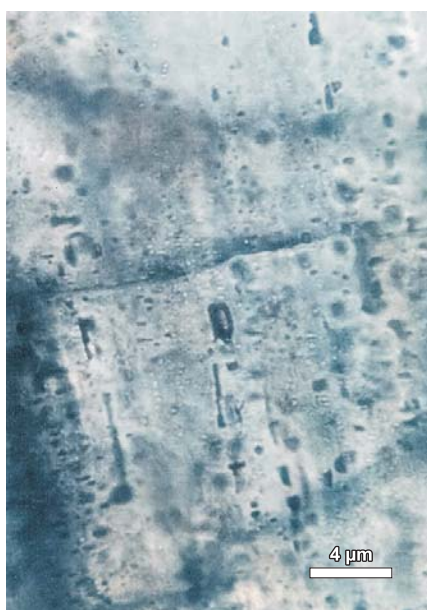
Ryc. 4. Jednofazowe inkluzje w cementie anhydrytowym. Otwór wiertniczy Paproć-9, głęb. 2634,1 m. Światło przechodzące, 1 nikol
