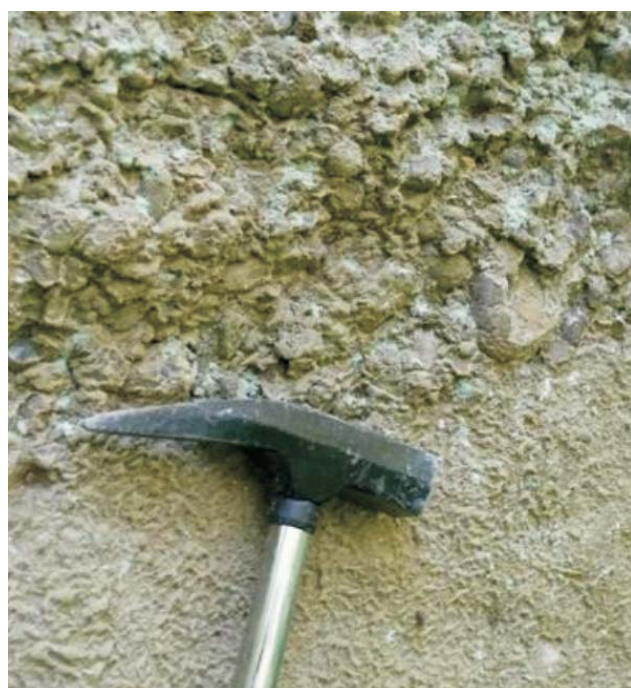
Ryc. 20. Fragment ławicy piaskowca w odsłonięciu u podnóża zamku, z widocznym przejściem frakcji średnioziarnistej w zlepieńcowatą. Materiał z tej charakterystycznej ławicy kilkakrotnie pojawia się w murach zamku. Ryc. 19–20 fot. M. Korzeniowski
