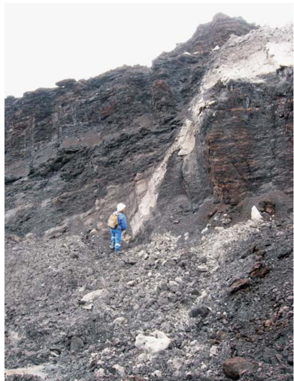
Ryc. 3. Kontakt tektoniczny pokładu I węgla brunatnego z pokładem II na uskoku głównym w KWB Turów. Fot. W. Zuchiewicz
