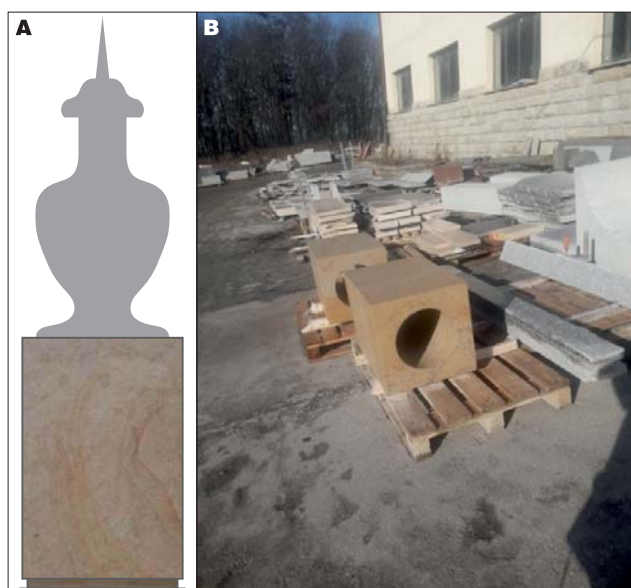
Ryc. 3. Postumenty z piaskowca: A – projekt; B – w zakładzie kamieniarskim przygotowane do wysyłki. Fot. B. Skolak Fig. 3. Sandstone pedestals: A – design; B – at the stone factory ready to shipping. Photo by B. Skolak
