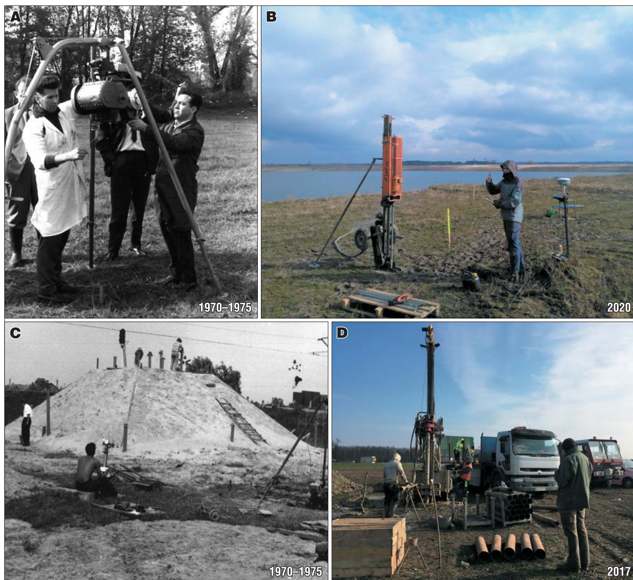
Ryc. 8. A – eksperymentalne badania parametrów fizycznych gruntu na potrzeby rozpoznania warunków geologiczno-inżynierskich. Prototyp wibromłota do wbijania sondy uniwersalnej w celu wykonania pomiarów oporności właściwej, oporu, wilgotności objętościowej i gęstości objętościowej gruntu na poligonie doświadczalnym. Pomiary wykonuje dr M. Borowczyk, pomysłodawca urządzenia. B – badania skarp rekultywowanych odkrywek kopalni węgla brunatnego w rejonie Adamowa w celu określenia ich stateczności. Sondowania sondą ciężką (DPH) wykorzystywane na potrzeby określenia stopnia zagęszczenia gruntów. C – badania presjometryczne wykonywane presjometrem Menarda oraz próbné pompowania na potrzeby odwadniania wykopów prowadzone w rejonie budowy elektrowni Dolna Odra k. Gryfina. D – wiercenia geologiczno-inżynierskie o głębokości 50 m metodą obrotową rdzeniową wykonywane na poligonie badawczym w rejonie archiwum próbek geologicznych w Leszczach. Doświadczenia z wykonanych prac zostały wykorzystane do opracowania Wytycznych wykonywania badań podłoża gruntowego na potrzeby budownictwa drogowego (Wytyczne, 2018)
