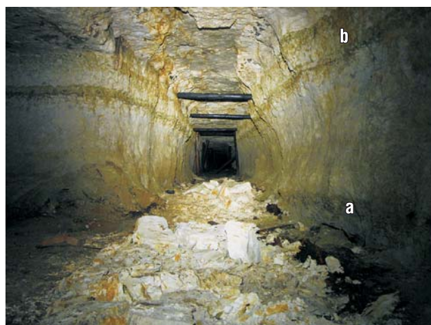
Ryc. 3. Korytarz nieczynnej kopalni fosforytów ( Jan 1 ) w Annopolu. W dolnej części po prawej stronie widoczna warstwa fosforytonośna albu (a), wyżej – dwa poziomy twarde den na granicy cenoman–turon (b). Fot. A. Komorowski
