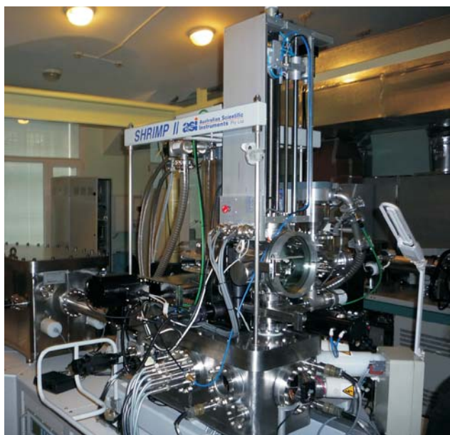
Ryc. 7. Aparatura SHRIMP-2 służąca do nowoczesnej geochronologii minerałów. Obie fot. M. Graniczny
