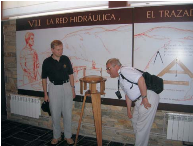
Ryc. 11. Teodolit z czasów rzymskich – dioptra w zbiorach muzeum w Las Médulas (po lewej dr inż. Andrzej Chmiela z Politechniki Śląskiej)
