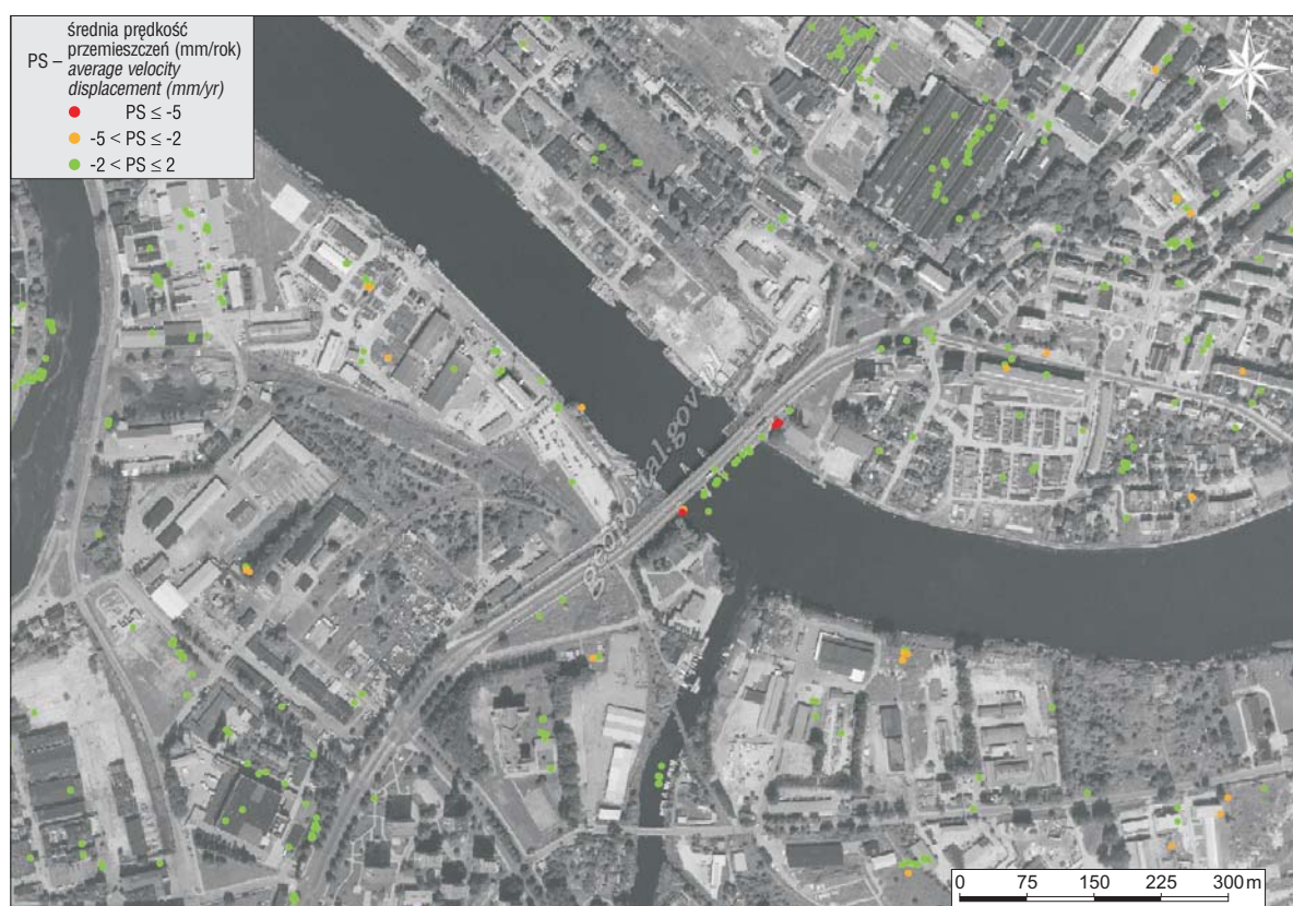
Ryc. 4. Osiadanie zarejestrowane na filarach mostu Siennickiego, centralna część mostu jest stabilna – wschodnia część Gdańska. W tle ortofotomapa pobrana z www.geoportal.gov.pl
