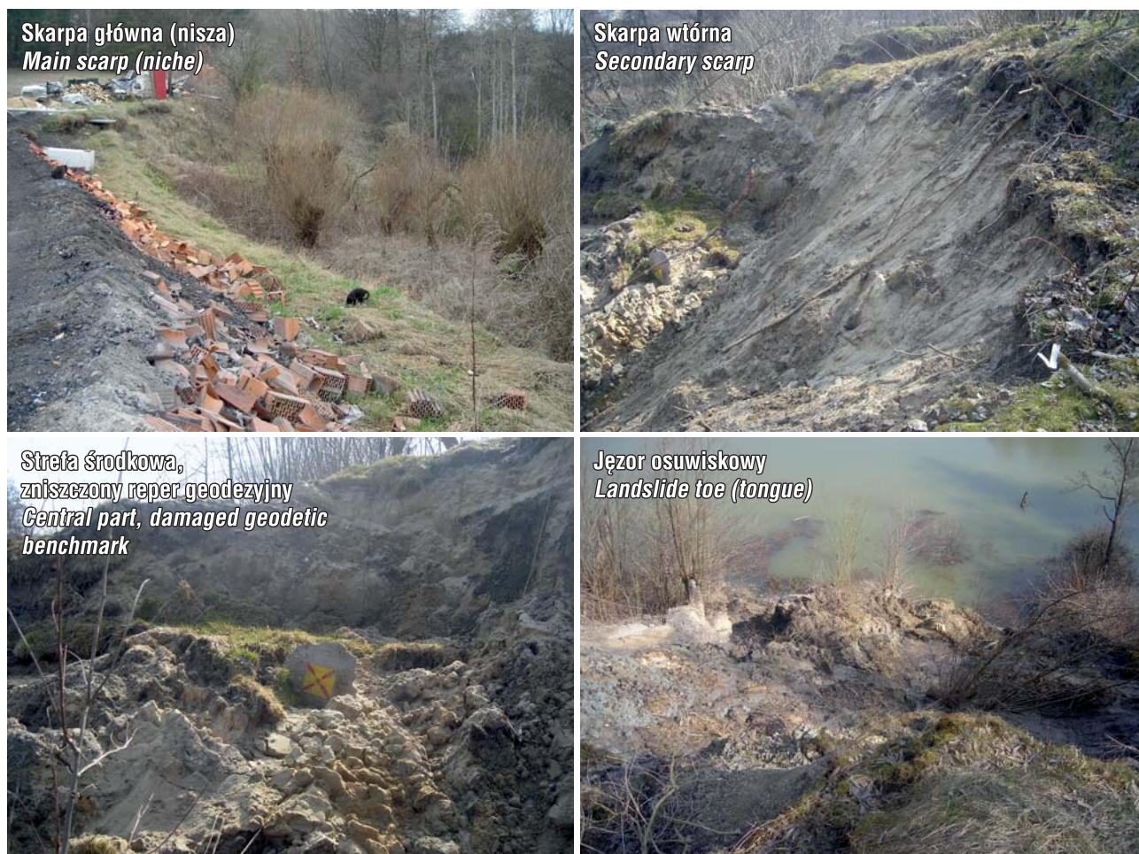
Ryc. 5. Widok osuwiska O po wystąpieniu deformacji w okresie wczesnowiosennym 2011 r. Fot. L. Zabuski
