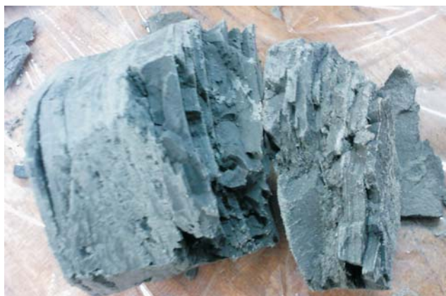
Ryc. 2. Próbkę wycinaną do badań w aparacie trójosiowego ściskania (ATS), która uległa zniszczeniu wynikającemu z jej warstwowej budowy (średnica próbeki – ok. 4 cm)
