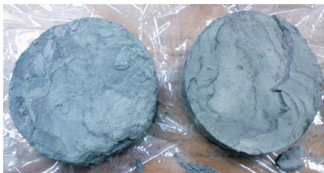
Ryc. 1. Warstwowa budowa gruntu widoczna na przełamach próbek (średnica próbek – ok. 10 cm)
