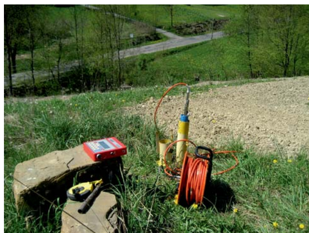
Ryc. 3. Monitoring inklinometryczny i piezometryczny Fig. 3. Inclinometer and piezometer monitoring
