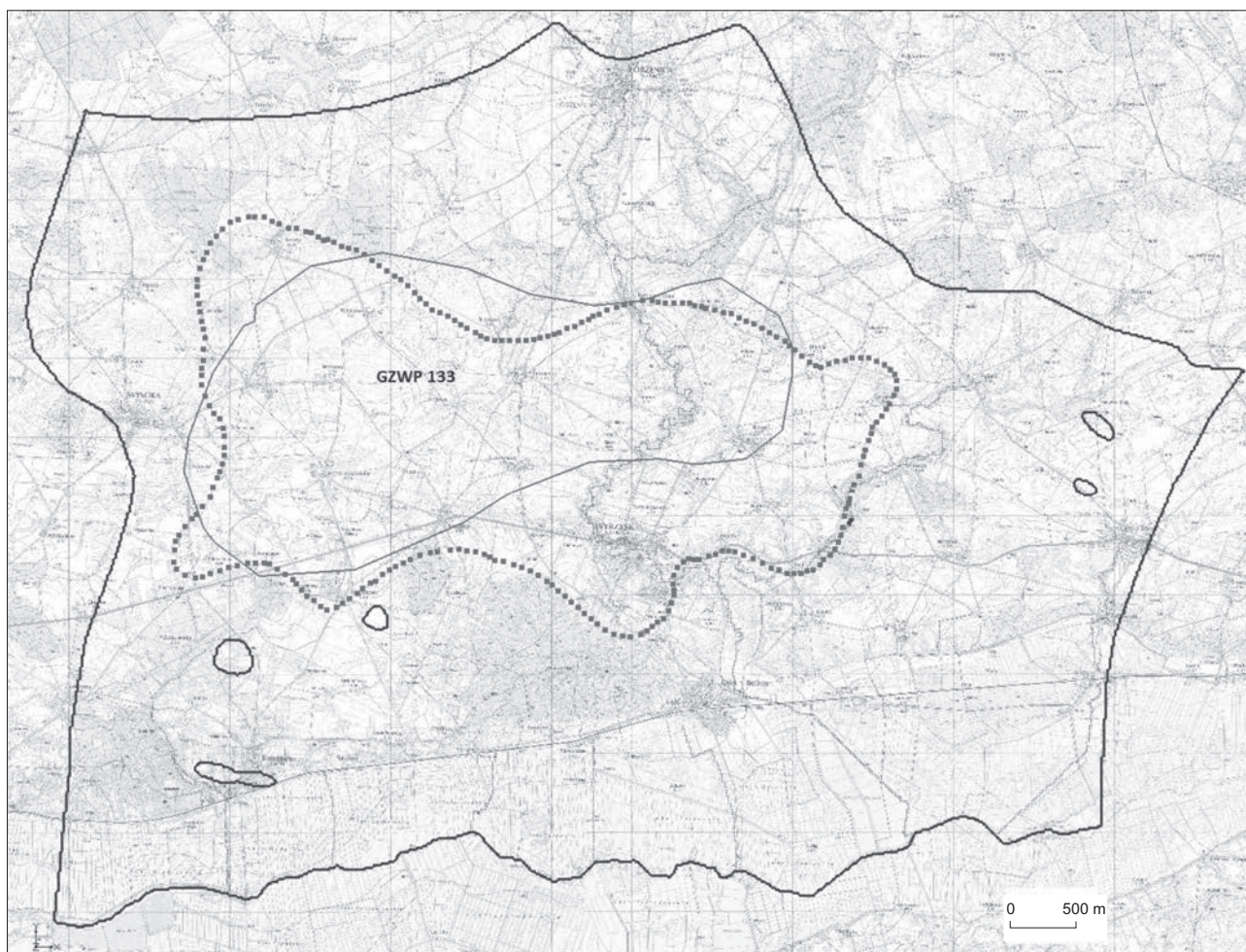
Ryc. 1. Obszar modelu. Linia ciągła – kształt zbiornika wg Kleczkowskiego (1990), linia przerywana – obliczony obszar zbiornika (podkład: mapa topograficzna 1 : 50 000, PUWG „1992”)
