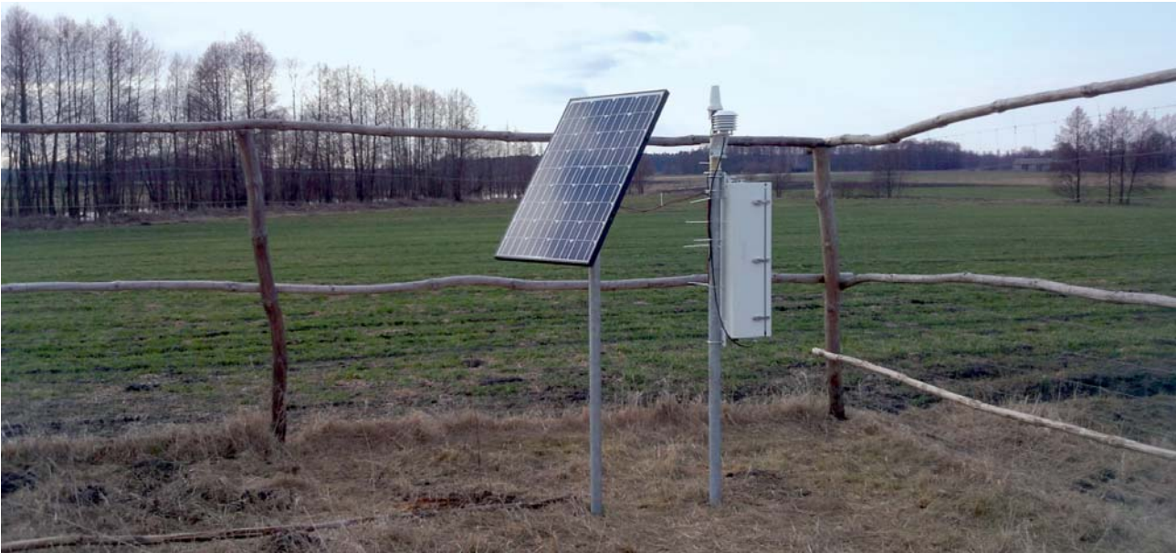
Ryc. 8. Czujnik Derło. Biała skrzynka po prawej stronie zawiera dwa liczniki neutronów, każdy z własnym modułem impulsów, rejestrator danych, modemem satelitarnym i akumulatorem (połączonym z panelem słonecznym, który jest na osobnym paliku po lewej stronie). Na pudle jest antena satelitarna (ścięty stożek z tyłu) i osłona mieszcząca czujniki temperatury i wilgotności względnej powietrza
