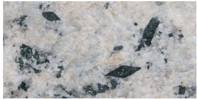
Ryc. 10. Automorficznie wykształcone kryształki hornblendy w granicie strzegomskim (szerokość pola widzenia ok. 1,5 cm; cokół domu handlowego, Rynek, długość pola widzenia ok. 2 cm). Fot. P. Zagożdżon
