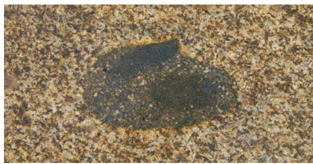
Ryc. 11. Maficzne „enklawy podwójne” – świadectwo wieloetapowego mieszania magm (stara płyta chodnikowa granitu strzegomskiego, ul. Łaciarska, długość pola widzenia ok. 30 cm). Fot. P. Zagożdżon
