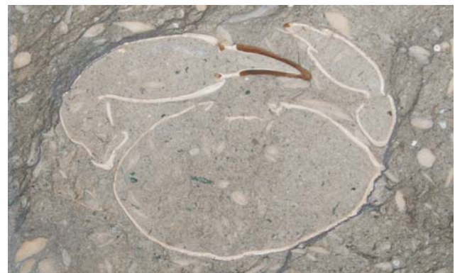
Ryc. 12. Przekrój pancerza kraba w hiszpańskim wapieniu Gris Alveolar (elewacja budynku u zbiegu ul. Jedności Narodowej i Namysłowskiej, długość pola widzenia ok. 10 cm). Fot. K. Zagożdżon
