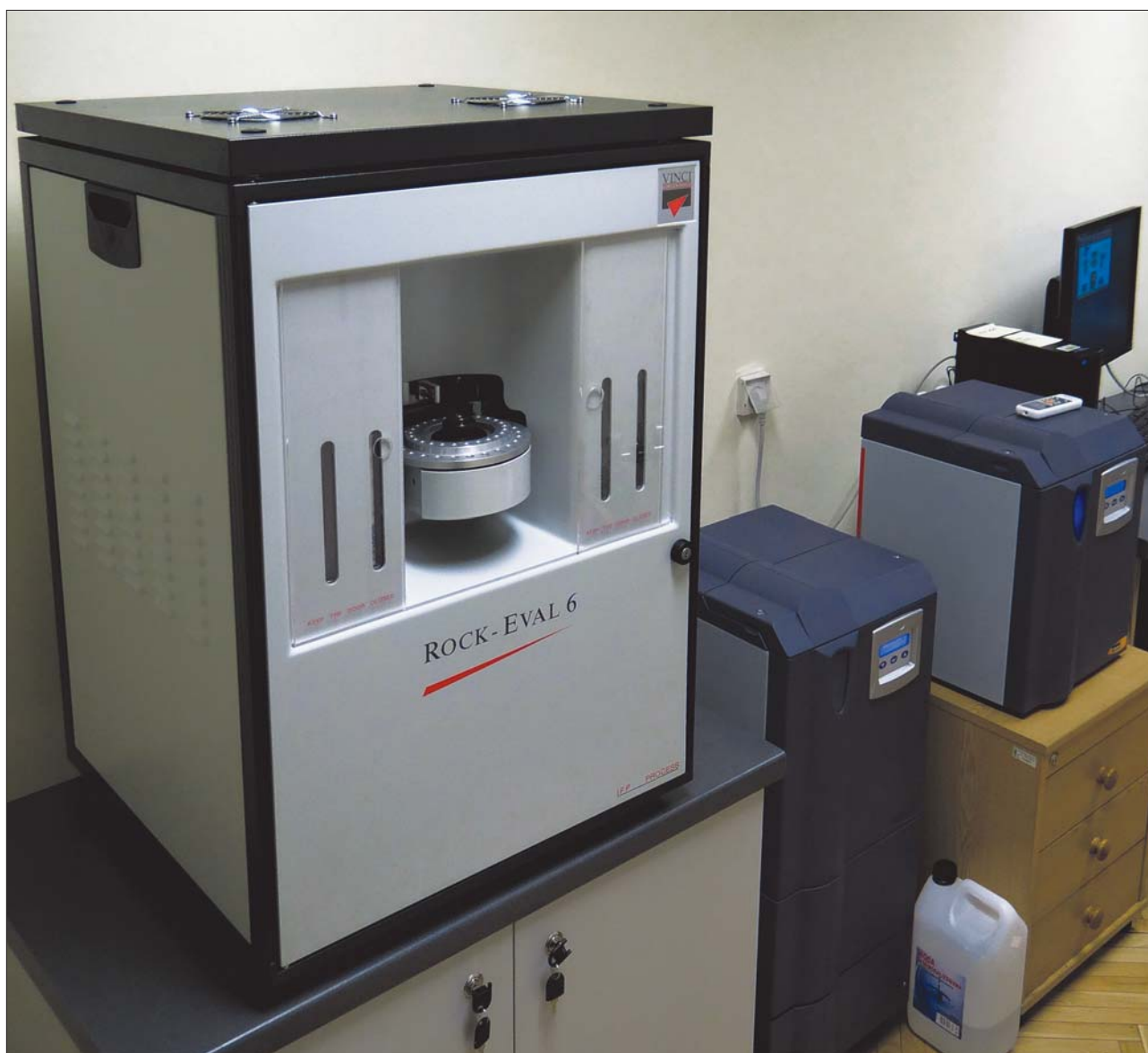
Aparat pirolityczny Rock Eval 6 w wersji Turbo firmy Vinci Technologies, który znajduje się na wyposażeniu PIG-PIB. Fot. P. Karcz
