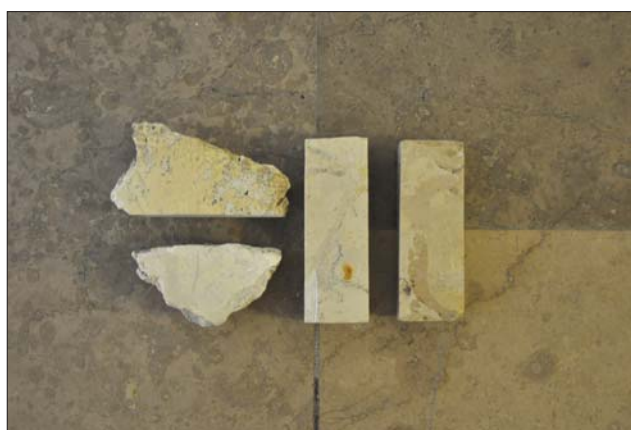
Ryc. 7. Makroskopowe wykształcenie badanych próbek na tle trzech odmian barwnych wapieni morawickich. Fot. B. Figarska-Warchoł Fig. 7. Hand specimen development of the rocks studied compared to that of the three coloured varieties of the Morawica limestones. Photo by B. Figarska-Warchoł
