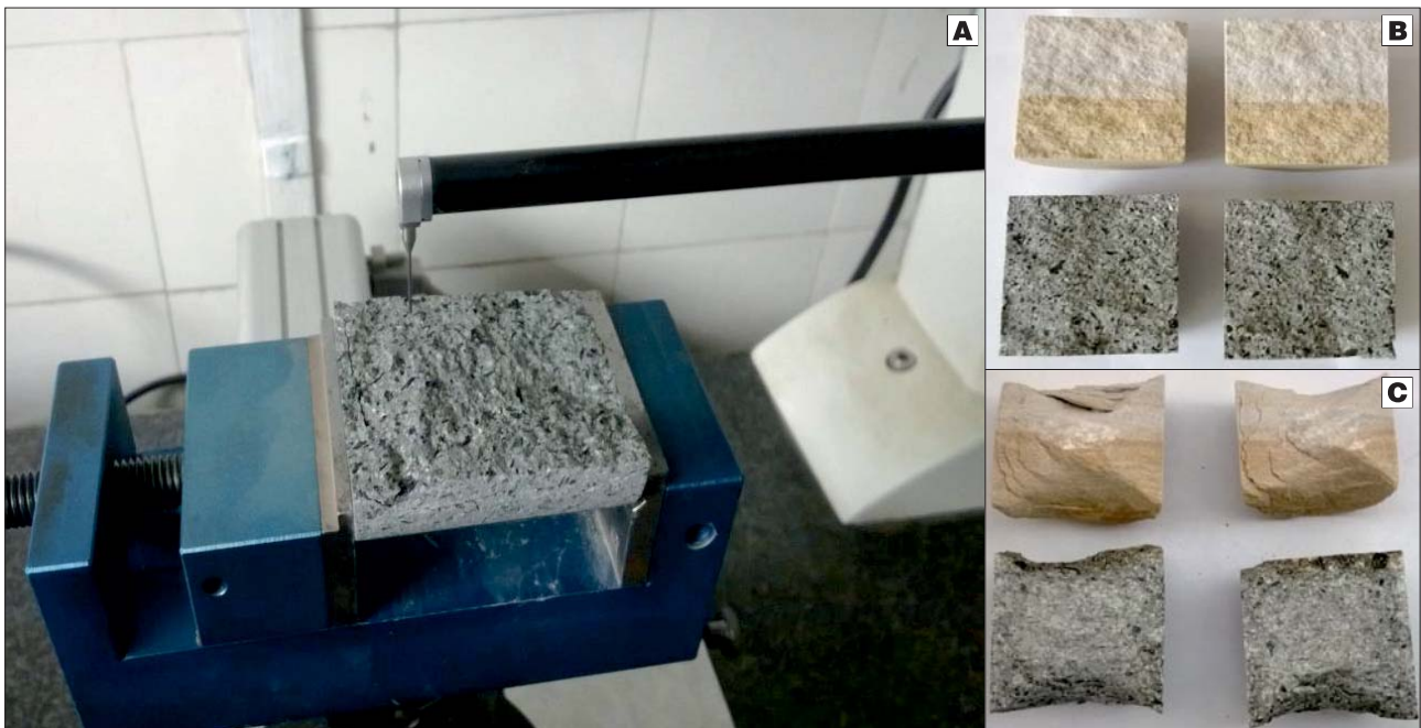
Ryc. 4. A – głowica pomiarowa profilometru Hommel Tester T8000 z przygotowaną do analizy chropowatości powierzchni próbką andezytu, B – powierzchnie rozdzielcze próbek piaskowca i andezytu otrzymane podczas badania rozciągania metodą brazylijską, C – powierzchnie rozdzielcze próbek piaskowca i andezytu otrzymane podczas badania ścinania
