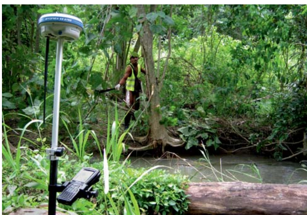
Ryc. 7. Pomiary geodezyjne przy wyznaczaniu lokalizacji profili ERT Fig. 7. Geodetic measurements during determining the location of ERT profiles
