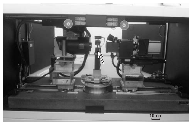
Ryc. 2. Walcowa próbka w komorze mikrotomografu Xradia MicroXCT-400, między lampą rentgenowską Hamamatsu L8121-034 (z lewej strony) a detektorem CCD (z prawej strony) Fig. 2. Cylindrical sample in a chamber of the MicroXCT-400 Xradia microtomography, between the Hamamatsu L8121-034 X-ray source (left) and the CCD detector (right)
