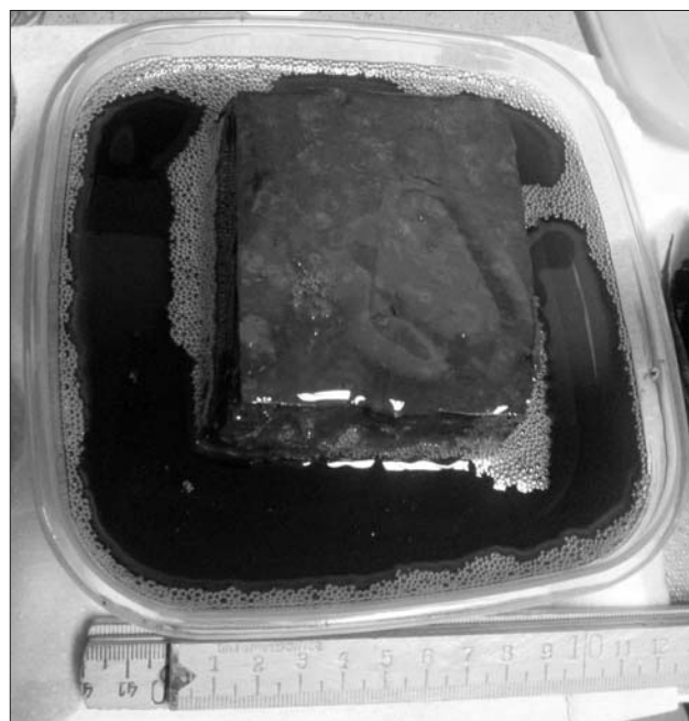
Ryc. 1. Przygotowywana próbka iłu (zabezpieczona przed wysychaniem) do badania w mikrotomografii
