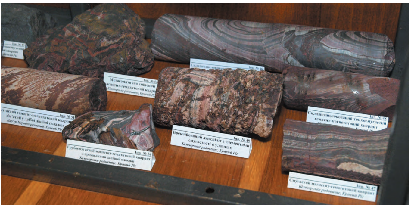
Ryc. 7. Fragmenty rdzeni z otworów wiertniczych w krzyworskich złożach rud żelaza. Wszystkie fot. A. Poberezhskyy
