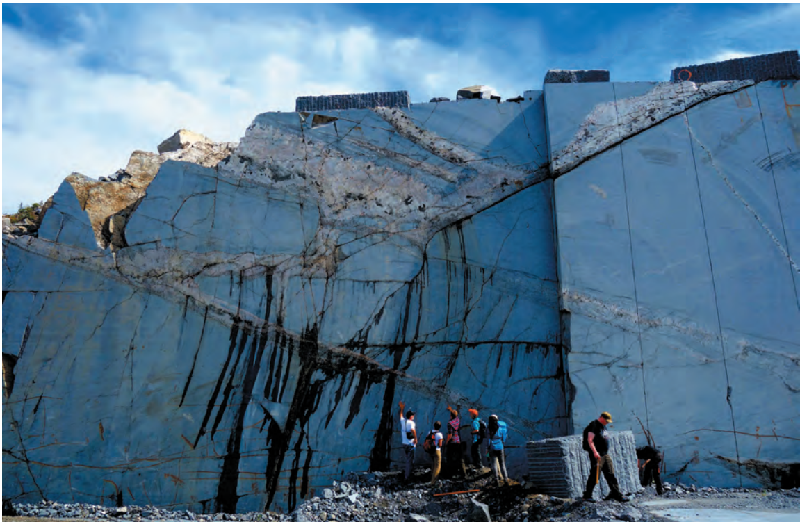
Ryc. 4. Kamieniołom larvikitu Johs Nilsen z żyłami pegmatytów sjenitowych. Uwagę zwraca sposób eksploatacji skały, z której bloki są wycinane za pomocą stalowych lin pokrytych proszkiem diamentowym. Dzięki temu bloki larvikitu mają gładkie powierzchnie. Obie fot. J. Janeczek
