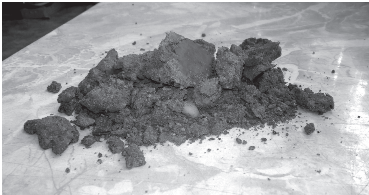
Ryc. 4. Próbka nr 3 – widoczne białe, obtoczone ziarno kwarcu o średnicy ok. 20 mm, u góry przecięta nożem bryła łu otoczona piaskiem Fig. 4. Sample 3 – visible white rounded quartz grain 20 mm in dia., higher – a knife-cut lump of clay with sandy grains around
