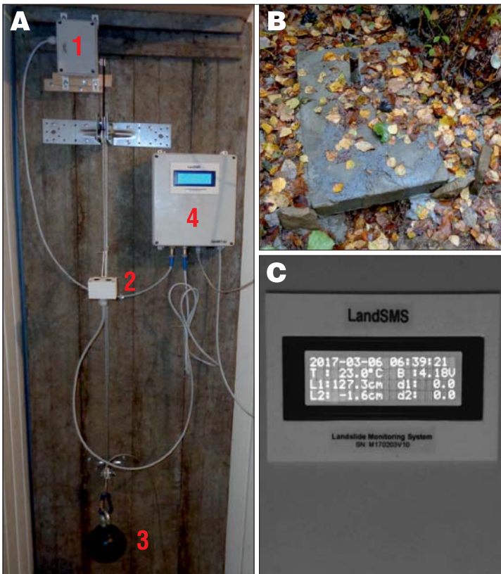
Ryc. 2. A – prototyp stacji monitorującej przemieszczenia gruntu LandSMS: 1 – enkoder, 2 – czujnik ultradźwiękowy, 3 – obciążenie o masie 5 kg utrzymujące stałą naciąg cięgna linowego, 4 – rejestrator; B – zastabilizowany punkt pomiarowy znajdujący się na osuwisku; C – rejestrator systemu LandSMS. Na wyświetlaczu są widoczne: data i godzina, T – temperatura, B – poziom napięcia baterii, L1 – długość odcinka pomiarowego od czujnika ultradźwiękowego do punktu referencyjnego (cm), L2 – względne zmiany długości bazy pomiarowej, mierzone enkoderem (cm), d1, d2 – zmiana wartości odpowiednio L1 i L2 w ciągu ostatniej godziny
