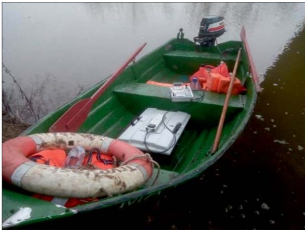
Ryc. 4. Zestaw MALÅ GroundExplorer (GX), 160 MHz przygotowany do pomiarów
