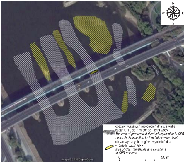
Ryc. 7. Obszary występowania wyraźnych przegłębień dna, progów i wyniesień w rejonie mostu w świetle badań GPR
