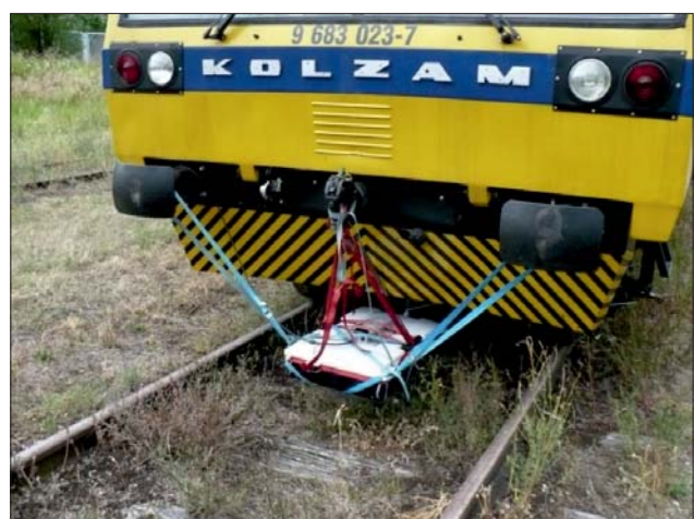
Ryc. 17. Sposób mocowania georadaru na drezynie. Fot. M. Maślakowski
