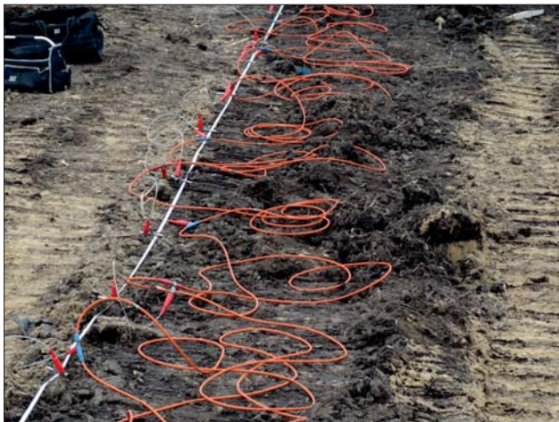
Ryc. 3. Układ pomiarowy ERT przygotowany do określenia rozkładu oporności elektrycznej podłoża. Fot. Maciej Maślakowski
