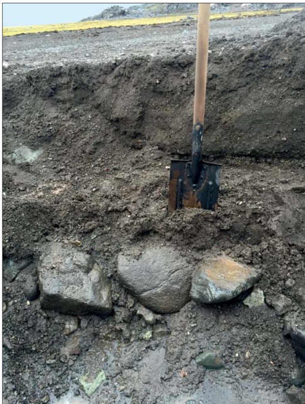
Ryc. 7. Warstwa bardzo gruboziarnistych gruntów na głębokości ok. 1 m p.p.t. na tle innych gruboziarnistych warstw
