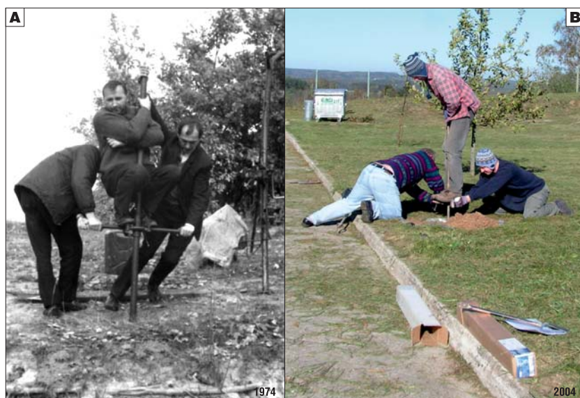
Ryc. 19. Wiercenia geologiczno-inżynierskie w roku 1974 (A) i 2004 (B). Od ponad 50 lat techniki wierceń nie uległy zmianie (Arch. PIG-PIB, 1974, 2004)
