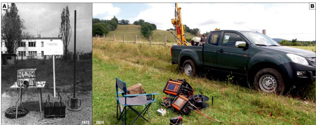
Ryc. 15. Aparatura do badań sejsmicznych wykorzystywana w geologii inżynierskiej w 1973 r. (A) (Frankowski i in., 1973) i w roku 2014 (B) (Arch. PIG-PIB, 2014)
