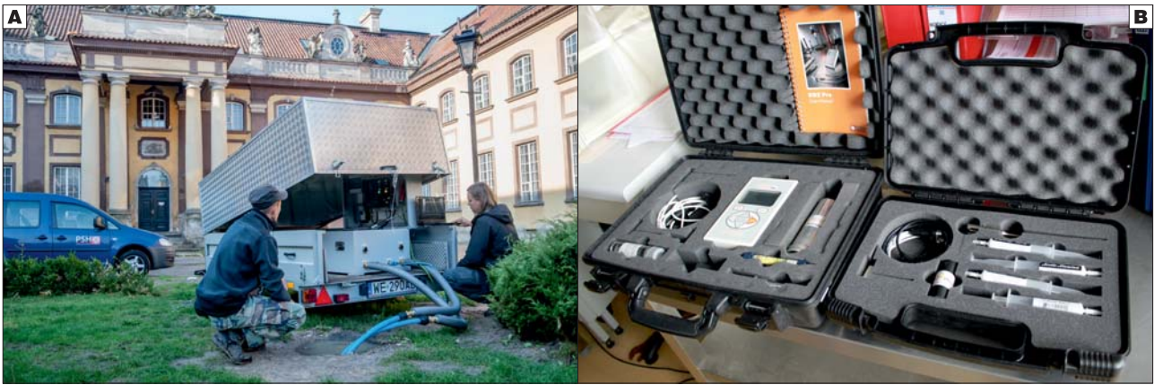
Ryc. 14. A – badanie polową sondą TRT (Arch. PIG-PIB, 2016); B – igła termiczna do badań laboratoryjnych (Arch. PIG-PIB, 2017) Fig. 14. A – Field Thermal Response Test (TRT) (Archive of PGI-NRI, 2016); B – thermal needle for laboratory tests (Archive of PGI-NRI, 2017)
