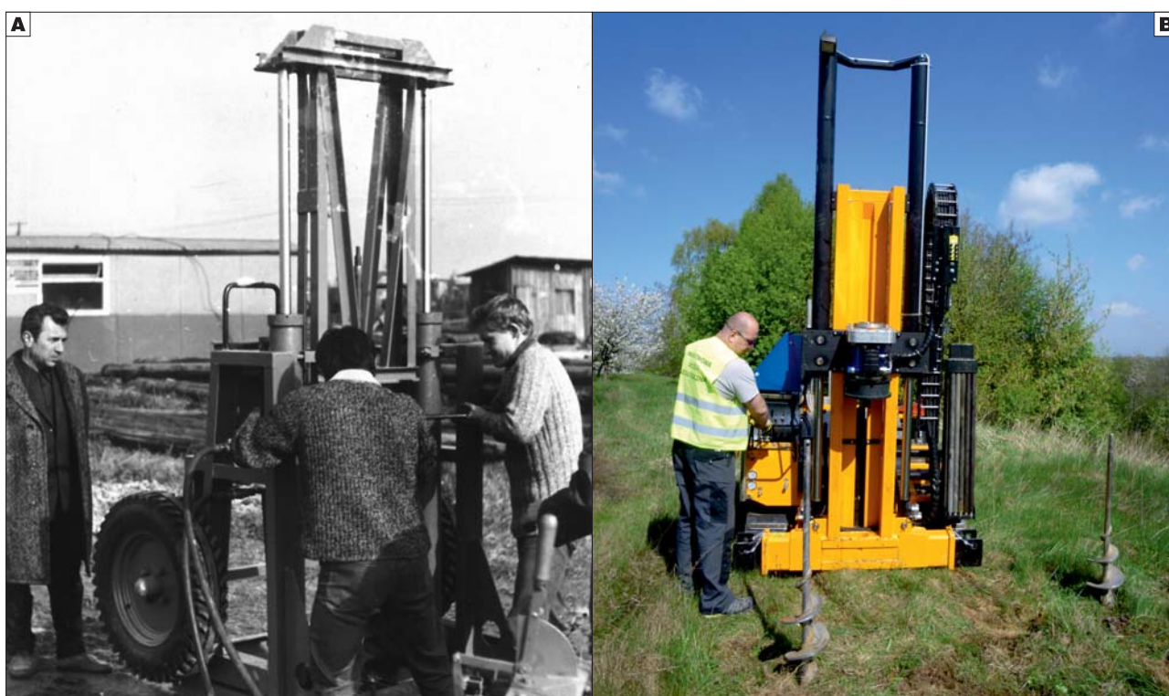
Ryc. 18. A – prototyp sondy statycznej (Arch. PIG-PIB, 1972); B – badanie sondą statyczną (Arch. PIG-PIB, 2016) Fig. 18. A – static probe prototype (Archive of PGI-NRI, 1972); B – static probe test (Archive of PGI-NRI, 2016)
