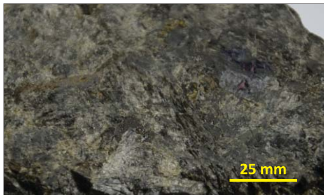
Ryc. 3. Powierzchnia płomieniowana labradorytu Volga Blue
