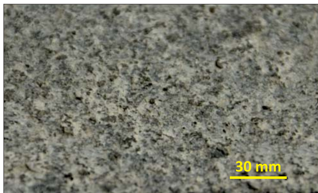
Ryc. 2. Powierzchnia płomieniowana granitu G603
