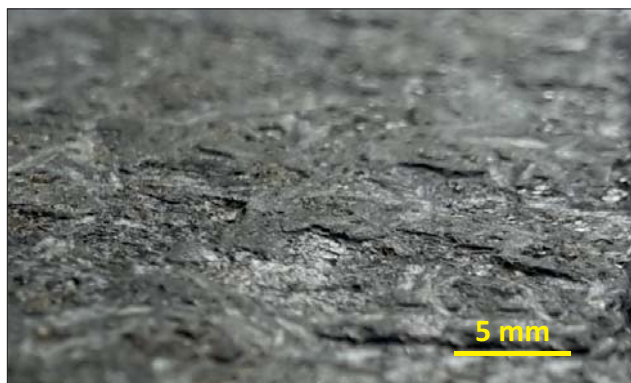
Ryc. 1. Powierzchnia płomieniowana granodiorytu Grey Super Dark
